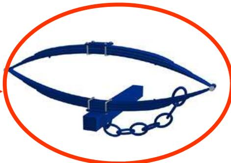
*M. Garrot, Ingénieur à Paris déposa en 1805* un brevet décrivant un "nouveau système de suspension des voitures" qui perfectionne l'utilisation des ressorts à lames.
