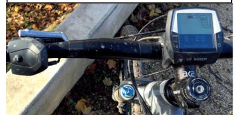
Le mini-tableau de bord avec affichage de la charge, etc., et le bloc de commande, à gauche, pour régler l'intensité de l'assistance.
